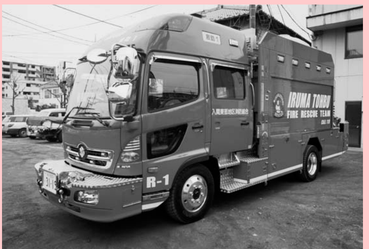
悪路を走破する4WDシャーシに、照明装置、車両用クレーン、前後引きウインチなどを搭載。高度救助資機材も積載しています。
