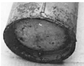
容器がさびた消火器
