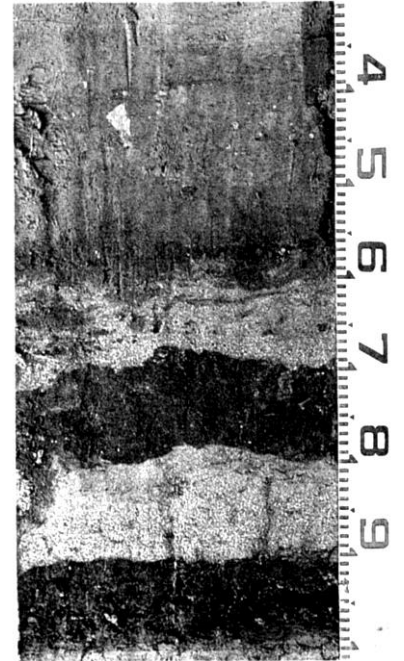
目盛り6~7の灰色層が貞観津波、8~9の灰色の層が5世紀の津波で運ばれた砂=産業技術総合研究所提供(朝日新聞2001.5.19)
